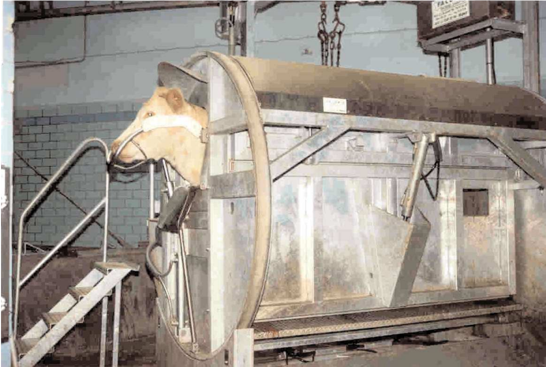
Figuur 6.3 Aangepaste Weinberg roterende installatie, waarmee in Oostenrijk ritueel geslacht wordt. De halssnede wordt bij onbedwelmde dieren uitgevoerd, waarna direct het kopschot volgt (Gsandtner, 2005).
